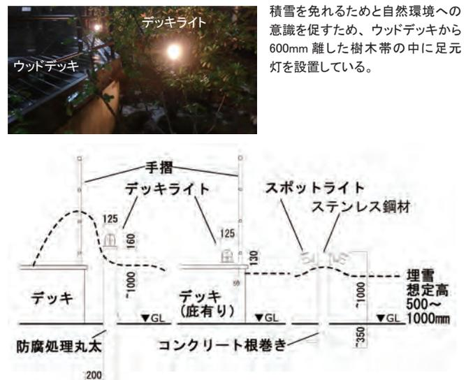
図8 照明器具配置断面
