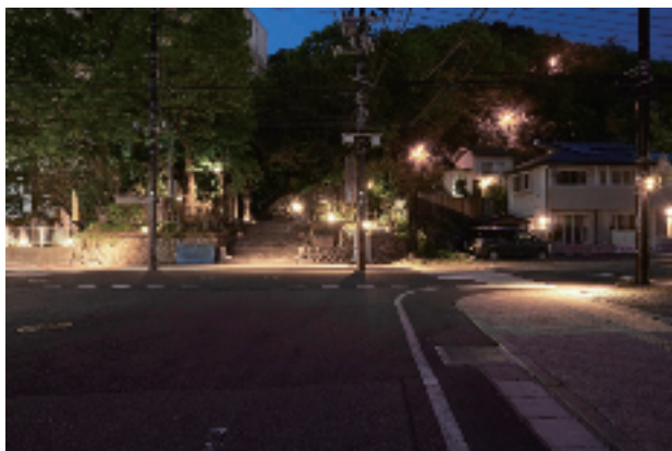
高台入口の空間要素を目立たせ、同時に交差点照明は危険予測照明とし、より入口部の視認性を高めた。階段部の足元灯はソーラー式を採用し、停電時も最低限階段を視認させる。
