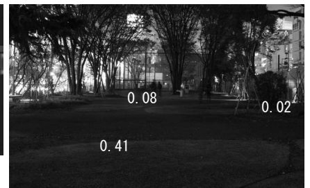
図 11 改修後の輝度分布 (cd/m 2 )
