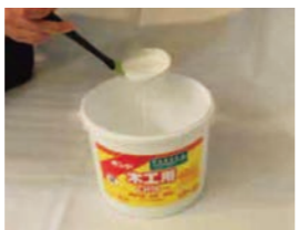
3. ボンド水をつくる ボンドと水を4:6の割合でよく混ぜる。
