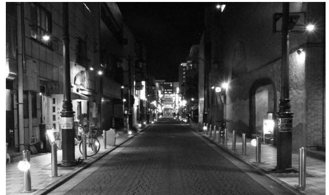
実験時は既存の高さ6mのポール灯を消灯し、高さ3.5mの位置にレフランプを下向きに取り付けた。また歩道の足元に電球を取り付けた。道路照明と沿道建物照明の、色・配置・強さなどが呼応するように調整されている。
