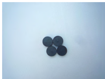
磁石（異方性フェライト） 直径×厚さ：φ 15 × 4mm 吸着力：350g 磁石の重さ：3.4g 表面磁束密度：890 ガウス
